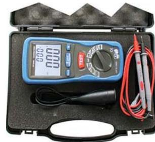
Tipo elettronico digitale a multifunzioni, con lettura su display, per la misurazione della resistenza di isolamento di apparecchiature elettriche, interruttori, cavi, motori, generatori con tensione di prova 250 V, 500 V, 1000 V, 2500 V.
